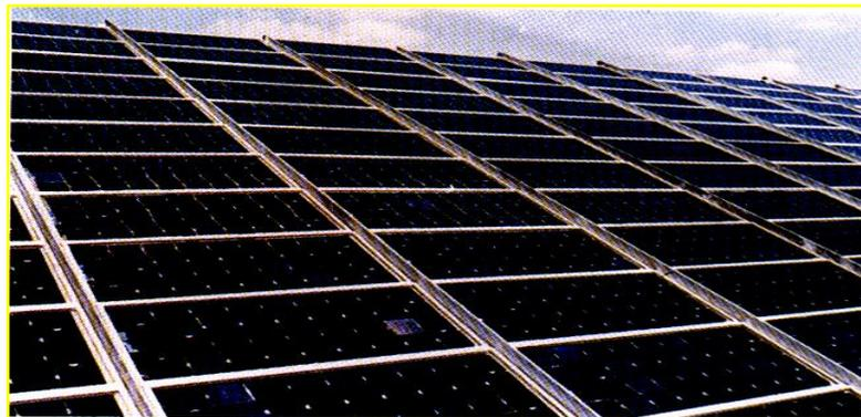
Pour augmenter la puissance, on groupe les modules PV en série/parallèle dans des champs PV
